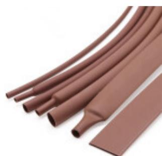
**CÓDIGO:** WI0805**MARCA:** Generica**DESCRIPCIÓN:** Tubo termocontraíble de color marrón. Sección antes de aplicar calor: Ø25mm, luego de aplicar calor: Ø12,8mm. Sin adhesivo. Fabricado en poliolefina. Contraíble a 90°C. Resiste hasta 600V.**CARACTERÍSTICAS:**
