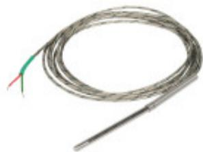
**CÓDIGO:** VE0308**MARCA:** Telergon**DESCRIPCIÓN:** Termocupla de hierro (Fe) y cobalto (Co), con rango de temperatura de 0 a 400°C, IP40, 3 metros de largo. Con dos cables tipo J para detección de temperatura.**CARACTERÍSTICAS:**
