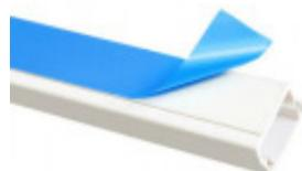
**CÓDIGO:** TA5021**MARCA:** Generica**DESCRIPCIÓN:** Ducto de pared fabricado en PVC rígido y aislante de color blanco, con cinta adhesiva. Dimensiones: ancho: 25mm, alto: 16mm, largo: 2 mts. Grado de protección: IP41. Combina simplicidad y estética, ofreciendo una solución para la distribución y ordenamiento del cableado en ambientes interiores**CARACTERÍSTICAS:** **Clase** - 2- Rígido
