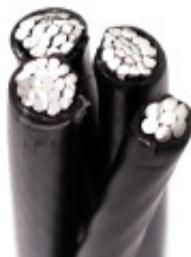
**CÓDIGO:** N11396**MARCA:** Generica**DESCRIPCIÓN:** Cable preensamblado de aluminio semirrígido Fucetix para distribución multipolar 3x95mm<sup>2</sup> + 1x54,6mm<sup>2</sup>, clase 2, aislado en XLPE. Para uso en distribución aérea de energía. Corriente admisible 230A@40°C. Normalizado UTE NMA 05.01/2.**CARACTERÍSTICAS:**
