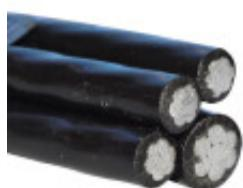
**CÓDIGO:** N11351**MARCA:** Generica**DESCRIPCIÓN:** Cable preensamblado de aluminio semirrígido Fucetix para distribución multipolar 3x50mm<sup>2</sup> + 1x54,6mm<sup>2</sup>, clase 2, aislado en XLPE. Para uso en distribución aérea de energía. Corriente admisible 150A@40°C. Normalizado UTE NMA 05.01/2.**CARACTERÍSTICAS:**
