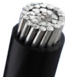
**CÓDIGO:** N09216**MARCA:** Generica**DESCRIPCIÓN:** Cable de aluminio puro semirrígido Fucelum 16mm<sup>2</sup>, clase 2, aislado en PVC. Para uso en distribución aérea de energía. Corriente admisible 74A**CARACTERÍSTICAS:**
