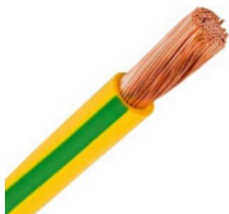
**CÓDIGO:** N03064**MARCA:** Generica**DESCRIPCIÓN:** Cable de cobre extra flexible Fustix CF 16mm<sup>2</sup>, clase 5, aislado PVC ecológico antillama. Color amarillo y verde. Uso en instalaciones fijas, industriales y domiciliarias. Apto para instalar en cañerías. Corriente admisible: en caño: 61A, en aire: 80A. Caída de tensión: 2,17 V/A por km. Bobina de 100 mt.**CARACTERÍSTICAS:**
