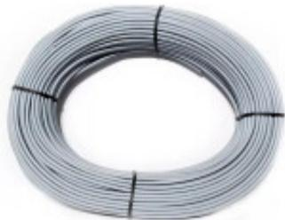
**CÓDIGO:** N03028R30**MARCA:** Generica**DESCRIPCIÓN:** Cable de cobre extra flexible Fustix CF 2,00 mm<sup>2</sup>, clase 5, aislado en PVC ecológico antillama. Color celeste. Uso en instalaciones fijas, industriales y domiciliarias. Apto para instalar en cañerías. Corriente admisible: en caño: 17A, en aire: 21A. Caída de tensión: 16,4 V/A por km, resistencia ohmica máxima 9,95O/Km, peso del cable 24kg/kilometro. Rollo de 30 metros.**CARACTERÍSTICAS:**
