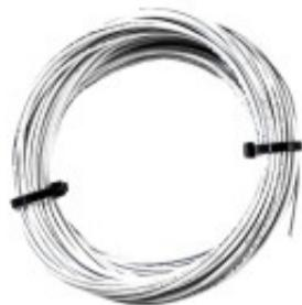
**CÓDIGO:** N03020R30**MARCA:** Generica**DESCRIPCIÓN:** Cable de cobre extra flexible Fustix CF 1,50 mm<sup>2</sup>, clase 5, aislado en PVC ecológico antillama. Color blanco. Uso en instalaciones fijas, industriales y domiciliarias. Apto para instalar en cañerías. Corriente admisible: en caño: 14,5A, en aire: 18A. Caída de tensión: 22,3 V/A por km, resistencia ohmica máxima 13,3/Km, peso del cable 18kg/kilometro. Rollo de 30 metros.**CARACTERÍSTICAS:**
